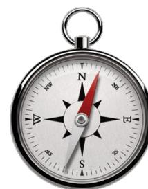
Par convention : on appelle pôle nord l'extrémité de l'aiguille aimantée qui pointe vers le nord magnétique terrestre, l'autre extrémité est le pôle sud. En règle générale, le pôle nord d'une boussole est représenté en rouge.
