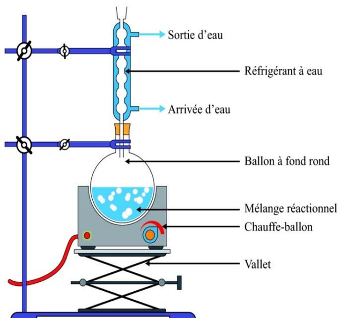
Lors d'une synthèse, on utilise un chauffage à reflux pour :
